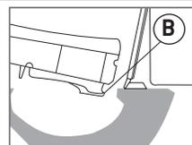
S'assurer que les rebords arrière (B) sont bien sous le bord arrière de la bordure de la cuvette.
