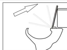
Lever le couvercle et le siège de toilette. Pour certaines cuvettes de toilette, il faudra peut-être enlever l'ensemble couvercle et siège pour une bonne installation.
