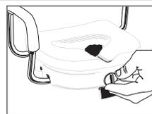
Serrer le siège de toilette surélevé en faisant tourner le bouton de réglage à la main dans le sens horaire jusqu'à ce qu'il soit bien fixé. **NE PAS TROP SERRER!**
