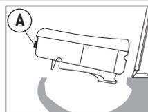
Placer le siège de toilette surélevé sur le rebord de la cuvette avec le bouton (A) orienté vers l'avant.
